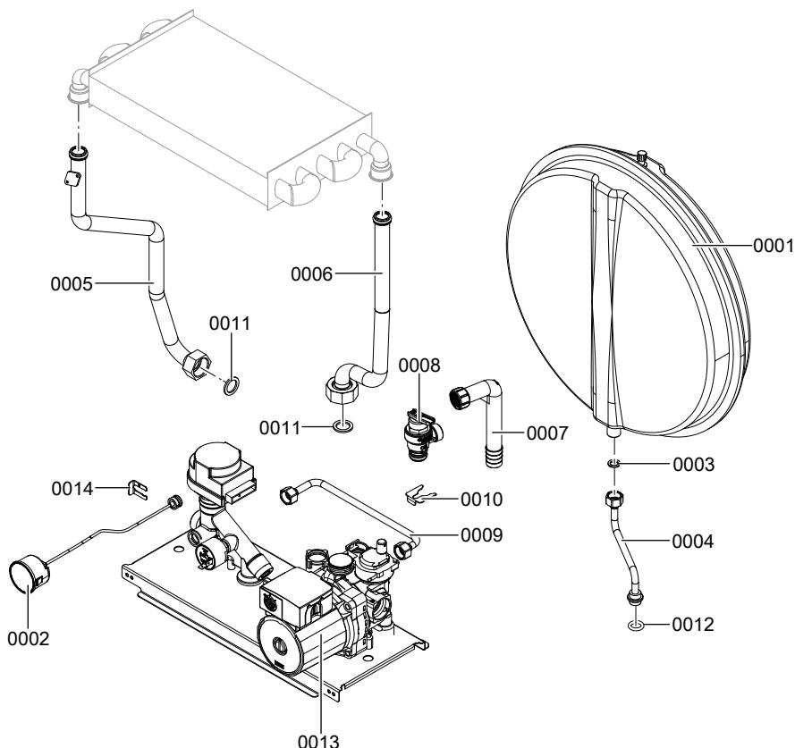
Спецификации деталей, номинальная тепловая мощность от 30 до 34 кВт
