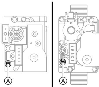
Ослабить, не вывинчивая, винт в измерительном штуцере **(A)** газовой регулирующей арматуры.
