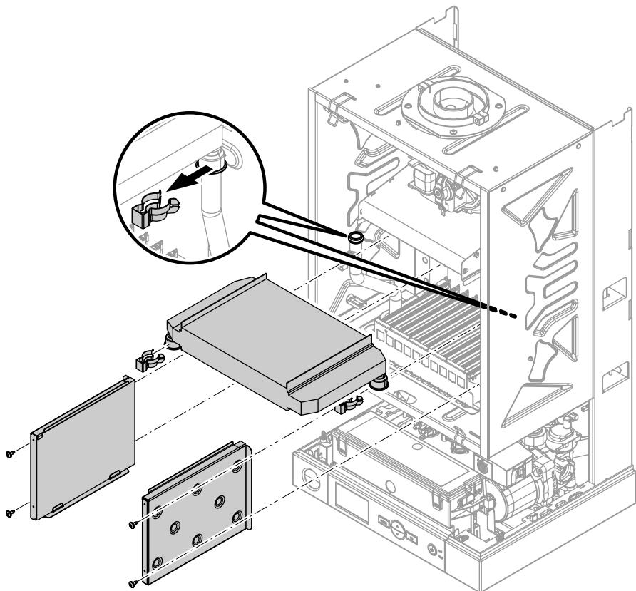
Если потребуется, продуть теплообменник уходящих газов сжатым воздухом или очистить мыльным раствором и промыть чистой водой.
