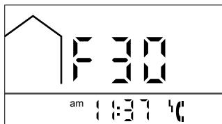
Неисправности отображаются на дисплее мигающим кодом (например, "F30") и символом неисправности или .
