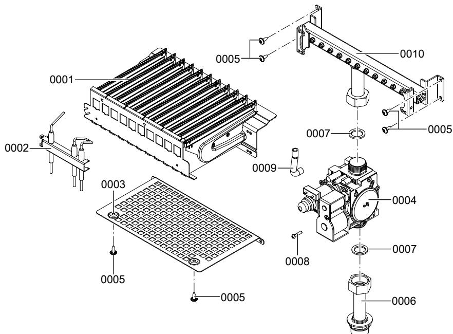
Спецификации деталей, номинальная тепловая мощность от 12 до 24 кВт
