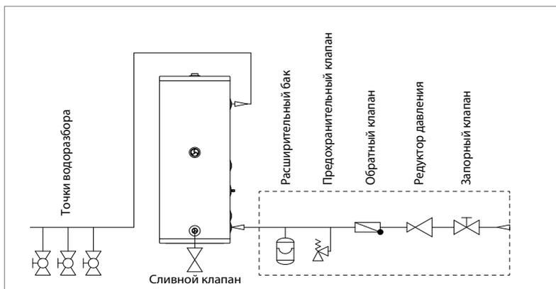
В случае превышения указанного в настоящей инструкции максимального рабочего давления воды, отсутствия предохранительного и обратного клапанов, а также при использовании не подходящих или неисправных соединительных фитингов, гарантия на водонагреватель утрачивает силу.
