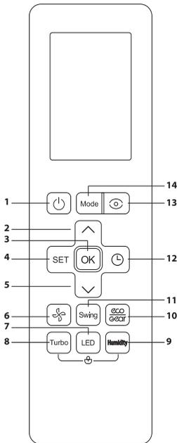
1. Кнопка ON/OFF – включение/выключение.
