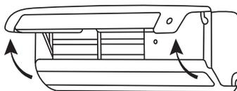
1. Поднимите верхнюю крышку для доступа к теплообменнику.
