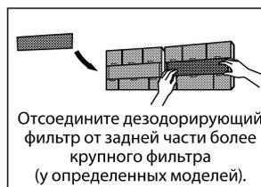
Отсоедините дезодорирующий фильтр от задней части более крупного фильтра (у определенных моделей).
