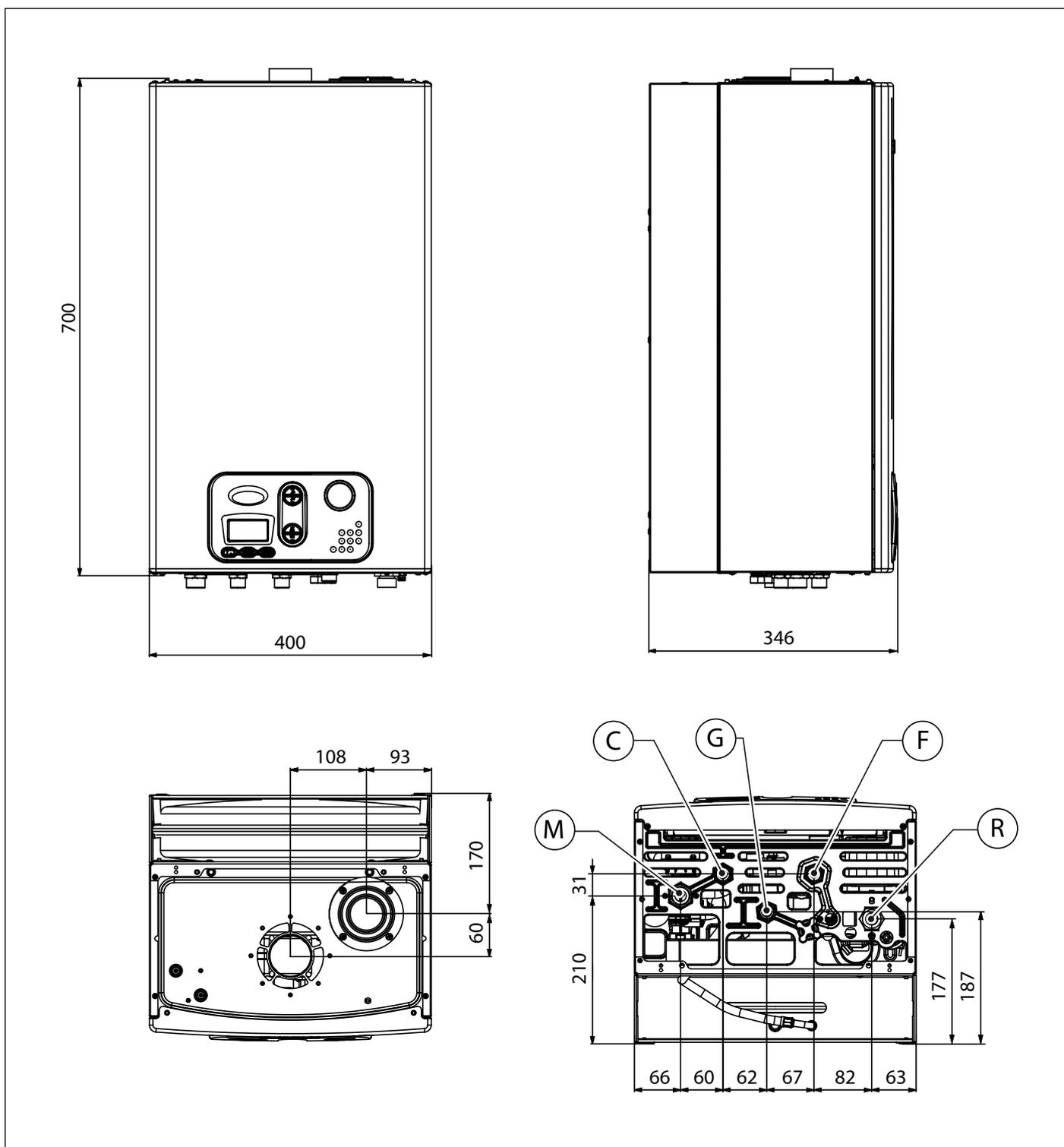
Рис. 3 Габаритные размеры
