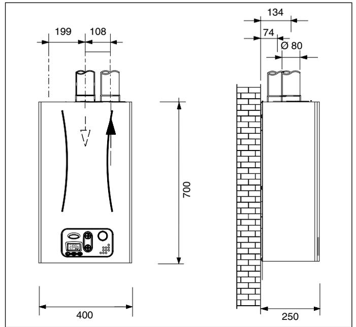
Рис. 9 Размеры для подсоединения отдельных труб воздухоподачи/дымоотвода
