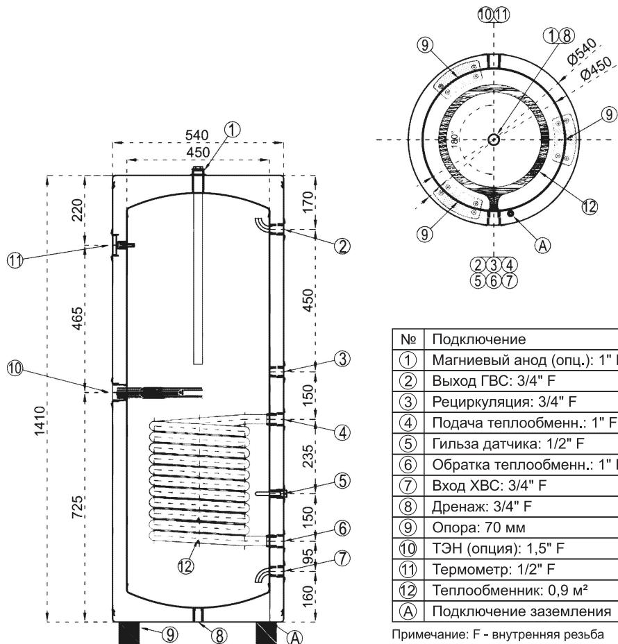
**Габаритные и монтажные размеры бойлера THERM X объемом 300 л**
