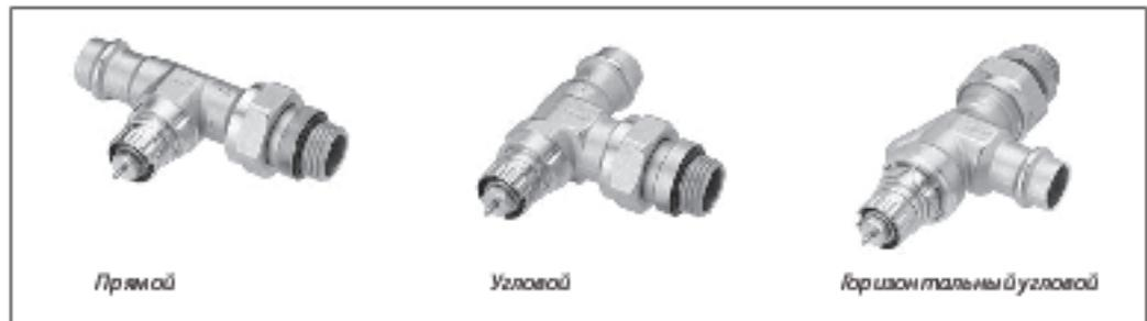
Клапан RA-N предназначен для применения в двухтрубных насосных системах водяного отопления с трубопроводами из меди или нержавеющей стали. Для соединения штуцера клапана с трубопроводом требуются специальные обжимные инструменты.
