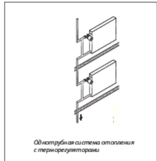
2. Диаметр клапана RTR-G следует выбирать по диаметру подводов.
