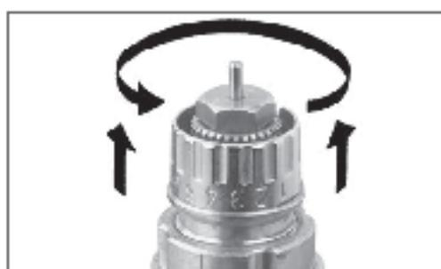
На настроечном устройстве клапанов указаны положения настройки от «1» до «7» и буква «N». Настройка может быть выполнена
