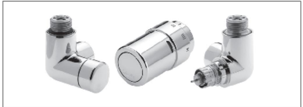
Терморегулирующий комплект X-tra™ специально разработан для полотенцесушителей. Он состоит из клапана терморегулятора, термостатического элемента и запорного клапана с дренажной функцией. Инновационное самоуплотняющееся присоединение клапана к радиатору осуществляется с помощью резьбы 1/2".
