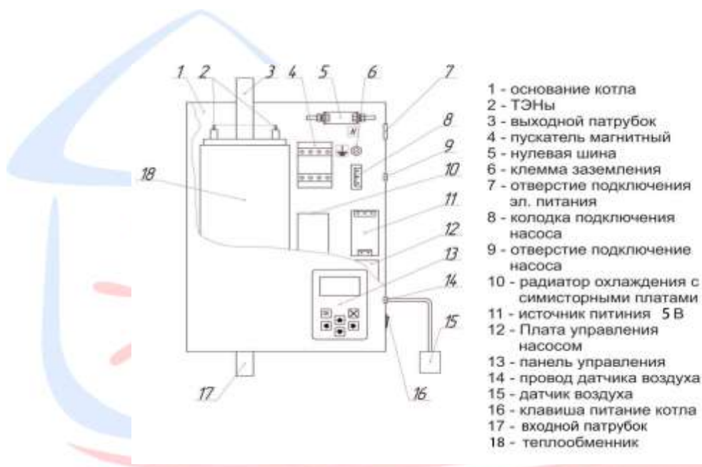
Рисунок 1. Устройство отопителя РЭКО серии П
