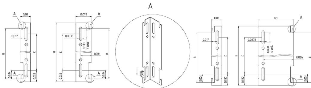
Предназначены для всех типов радиаторов с креплением Hook/Standart, кроме: CH10, CH20, CH30, VCH10, VCH20, VCH30
