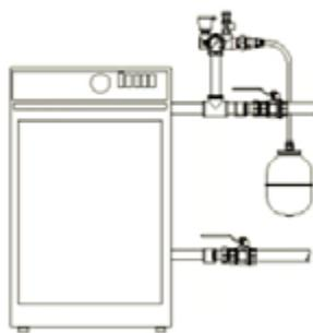
Если расширительный бак к группе безопасности не подключается, свободный резьбовой патрубок должен быть заглушен. При соединении сбросного патрубка предохранительного клапана с дренажной системой, следует обеспечить разрыв струи.
