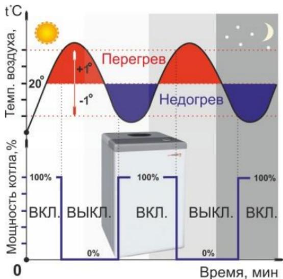
При управлении котлом в релейном режиме термостат или контроллер ZONT измеряет текущую температуру и при отклонении ее значения от заданных параметров, замыкает или размыкает контакты выходного реле, включая или выключая горелку.
