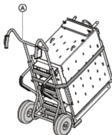
Поставляемое в качестве принадлежности приспособление для подачи на место установки (A) используется для транспортировки котла по коридорам и лестничным клеткам. Для транспортировки котла по лестничным клеткам необходимы 3-4 человека. При использовании приспособления для подачи на место установки, как правило, следует демонтировать дверцы. На приспособлении для подачи на место установки котел должен быть зафиксирован с помощью натяжного ремня.
