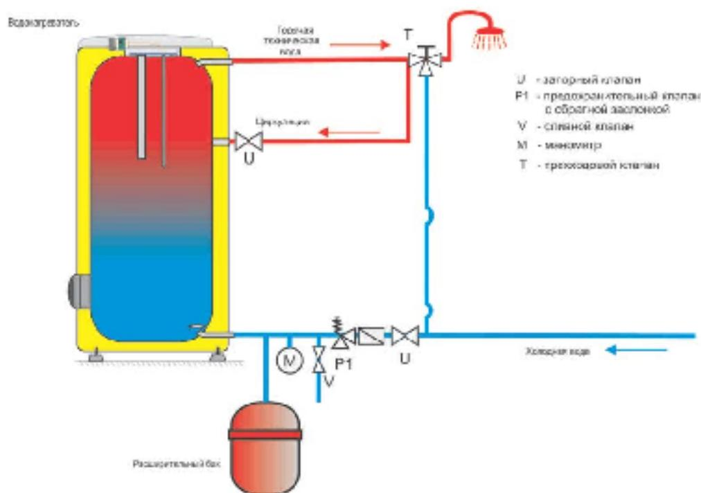
\* Использование расширительного бака не является условием правильного подключения, это лишь возможный вариант решения
