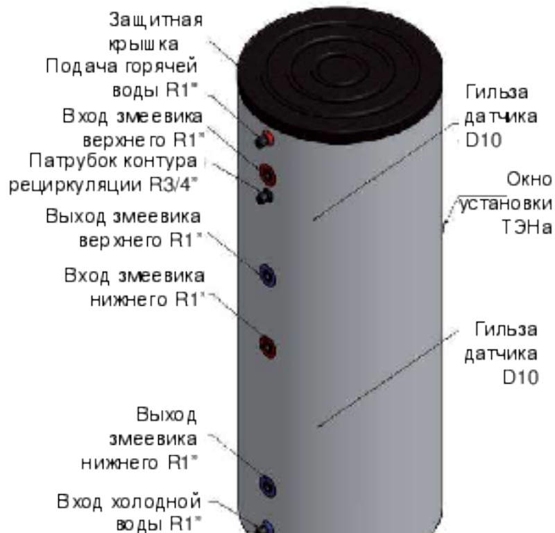
Водонагреватель с двумя теплообменниками-змеевиками 160-200 л
