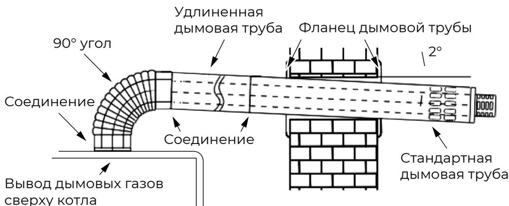
Рис. 30. Пример монтажа схемы C12.
