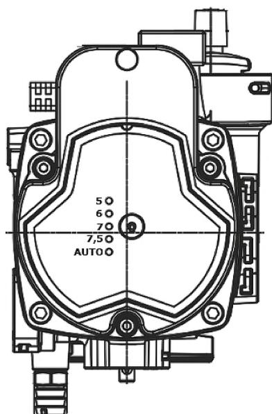
Рис. 26. Котловой циркуляционный насос.
