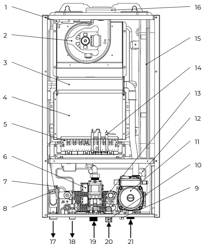
Рис. 2. Общая схема котлов V30 18 C, 24 C.
