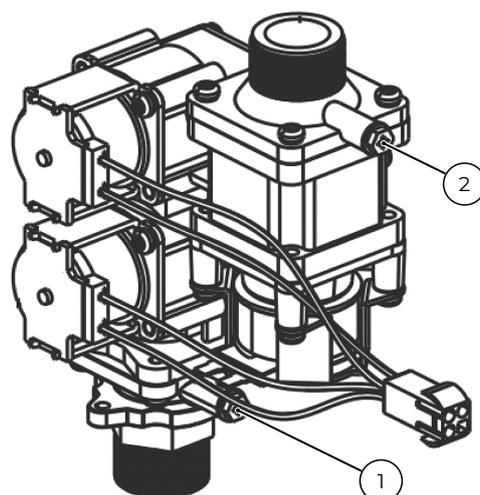
Рис. 25. Газовый клапан.
