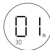
Рис. 19. Настройка времени задержки пуск котла в Эко-режиме.
