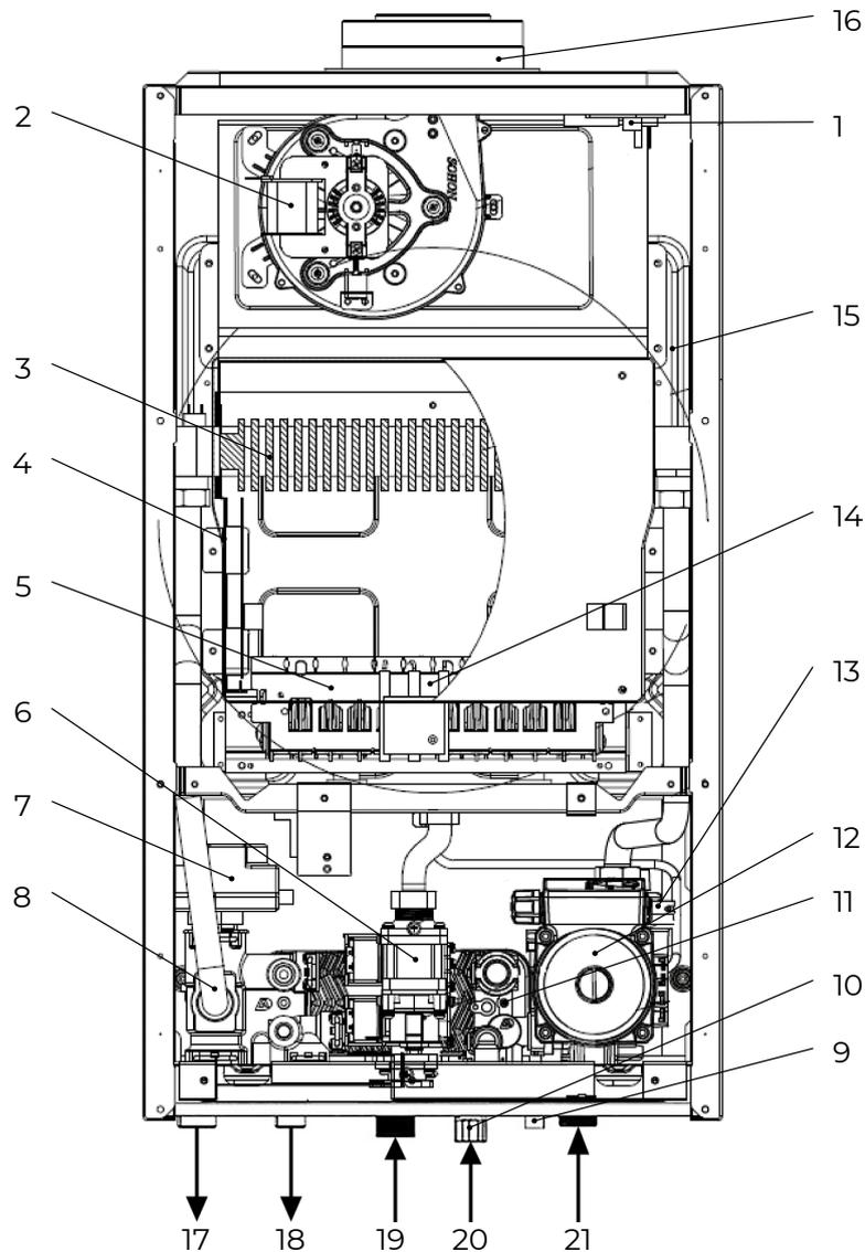
Рис. 3. Общая схема котлов B30 28 C, 32 C, 36 C.
