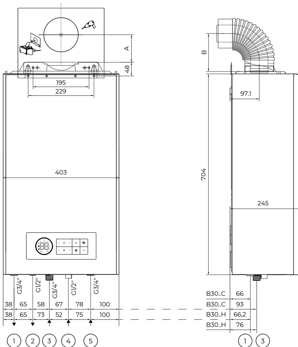
Рис. 27. Монтажные размеры V30 18 C/H, V30 24 C/H.
