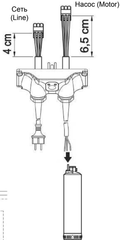
Рис. 3 Схема электрического подключения Pressdrive к насосу
