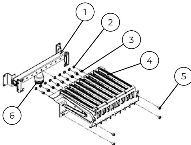
Рис. 24 Газовая горелка.
