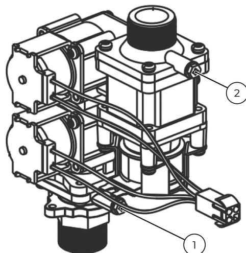
Рис. 25. Газовый клапан.
