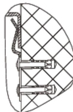
Заполните ванну на  $\frac{1}{3}$  объема и произведите герметизацию стыка ванны и стены с помощью силиконового герметика (аксессуар поставляется не входит) (показан к применению любой силиконовый герметик отвечающий свойствам физической и безопасности, противоглазности).
