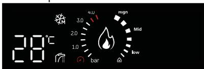
Регулировка температуры теплоносителя в системе отопления осуществляется при помощи ручки при этом на дисплее отображается устанавливаемое значение температуры.
