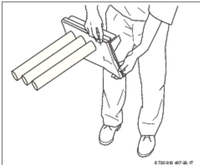
Рис. 41 Опрокидывание горелки
