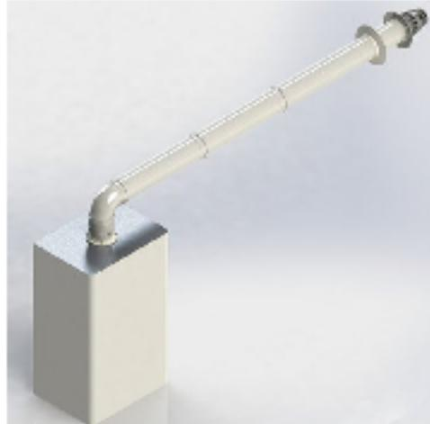
Системы дымоходов для конденсационных котлов производятся из высококачественного полипропилена, у коаксиальных систем внутренняя (дымоудаляющая) труба изготавливается из полипропилена, внешняя (воздухоподающая) изготавливается из оцинкованного металла, либо алюминия, либо полипропилена в зависимости от типа изделия. Максимальная рабочая температура 120 С ° и давление Н1 200 Pa.
