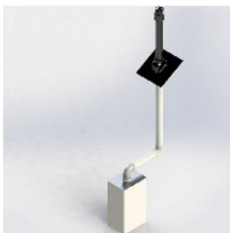
Системы дымоходов для традиционных неконденсационных котлов производятся из высококачественного алюминия, у коаксиальных систем внутренняя (дымоудаляющая) труба изготавливается из алюминия, внешняя (воздухоподающая) изготавливается из оцинкованного металла, либо алюминия, либо температуростойкого полипропилена в зависимости от типа изделия. Максимальная рабочая температура 200 С ° и давление Н1 200 Pa.
