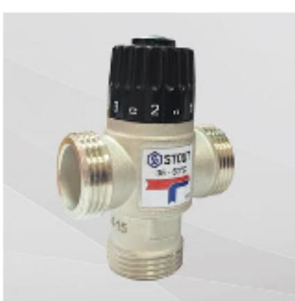
Терmostатические смесительные клапаны для тепловых генераторов на твердом топливе. Такие клапаны позволяют поддерживать высокую температуру рабочей жидкости на входе в котельную. Функция позволяет котельной поднять внутреннюю температуру даже на этапе включения. Таким образом устраняет риск наличия конденсата и снижает образование накипи на теплообменнике. Калибровка по температурному режиму 45-55-60-70°C. Диаметры подсоединения 1", 1 1/4"
