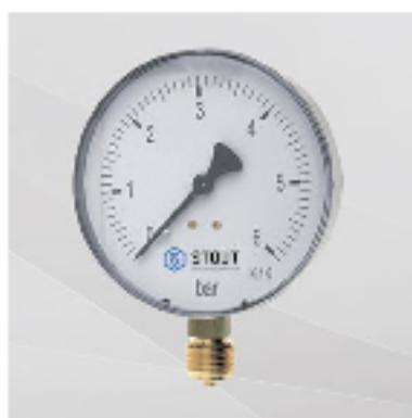
Манометры предназначены для измерения давления жидких и газообразных сред. Манометры аксиальные и радиальные для закрытых систем отопления. Диаметры 50; 63; 80 мм . диапазон измерений от 0 до 16 бар. Максимальная рабочая температура 80°C. Подключение -1/4; 3/8; или 1/2". Класс точности 1,6.
