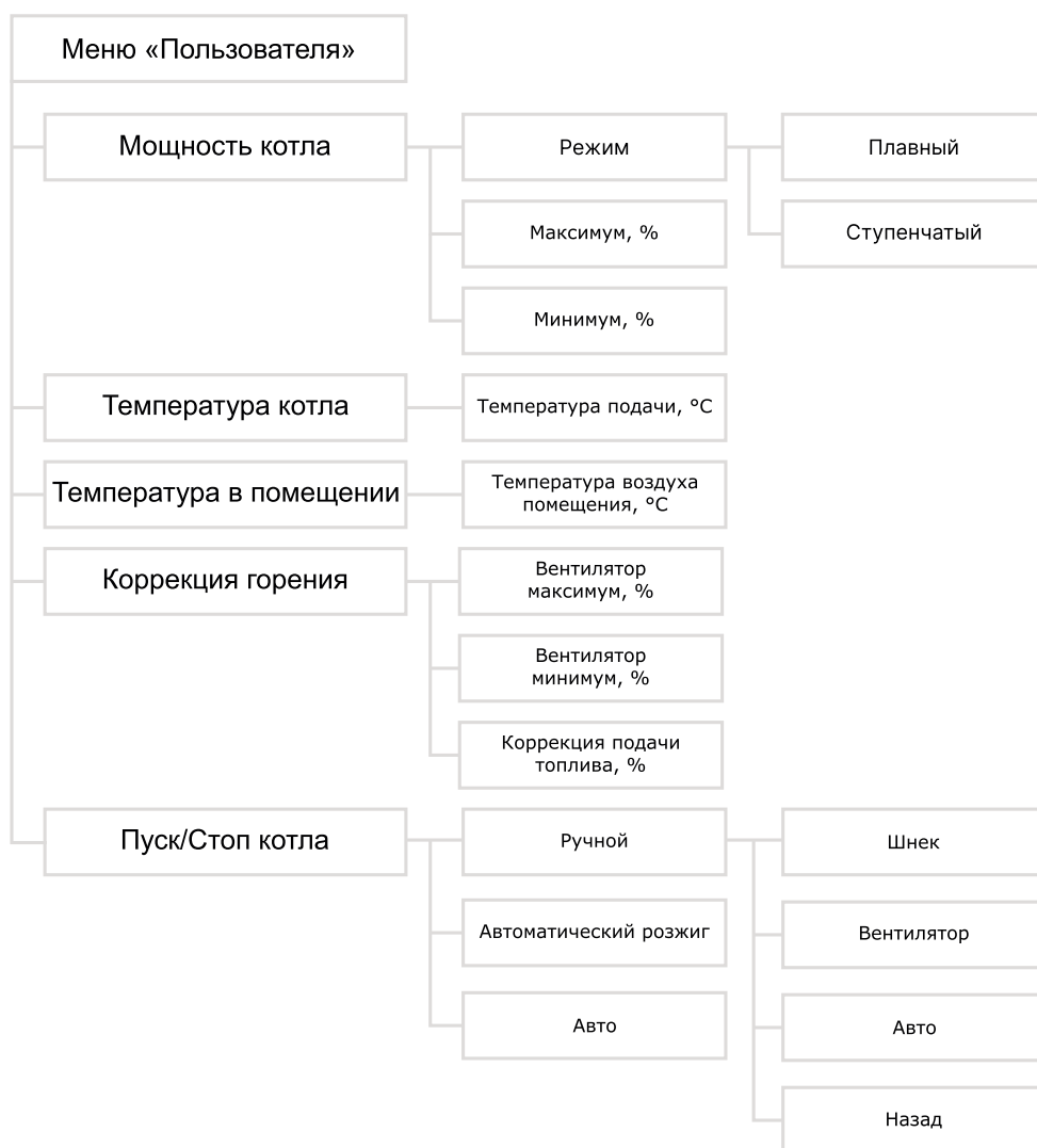
Рис.15 Блок-схема меню пользователя
