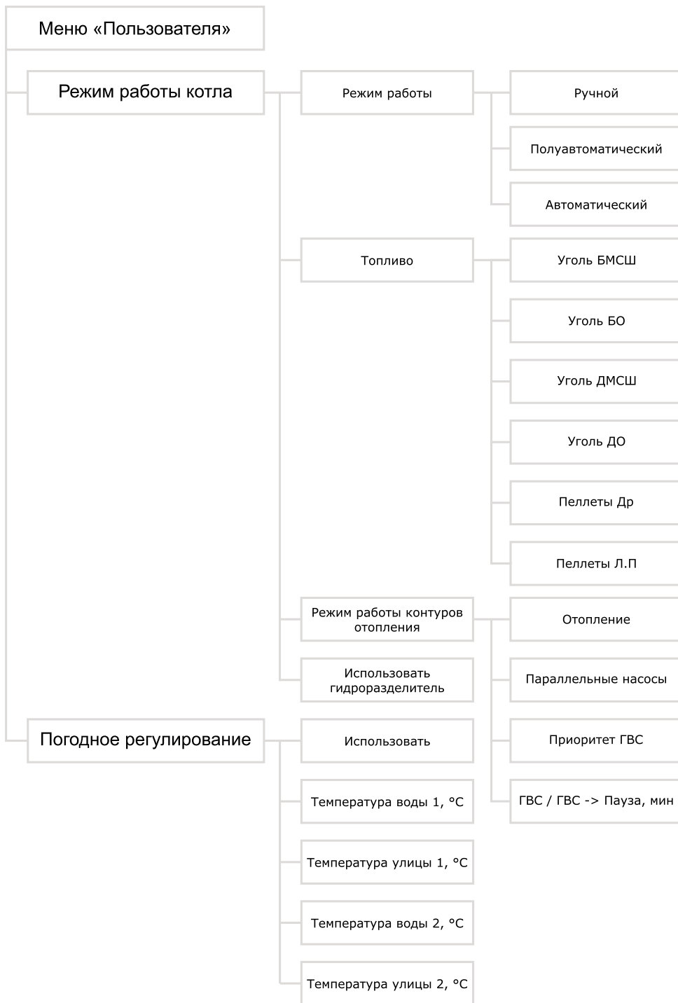
Рис.16 Блок-схема меню пользователя (продолжение)
