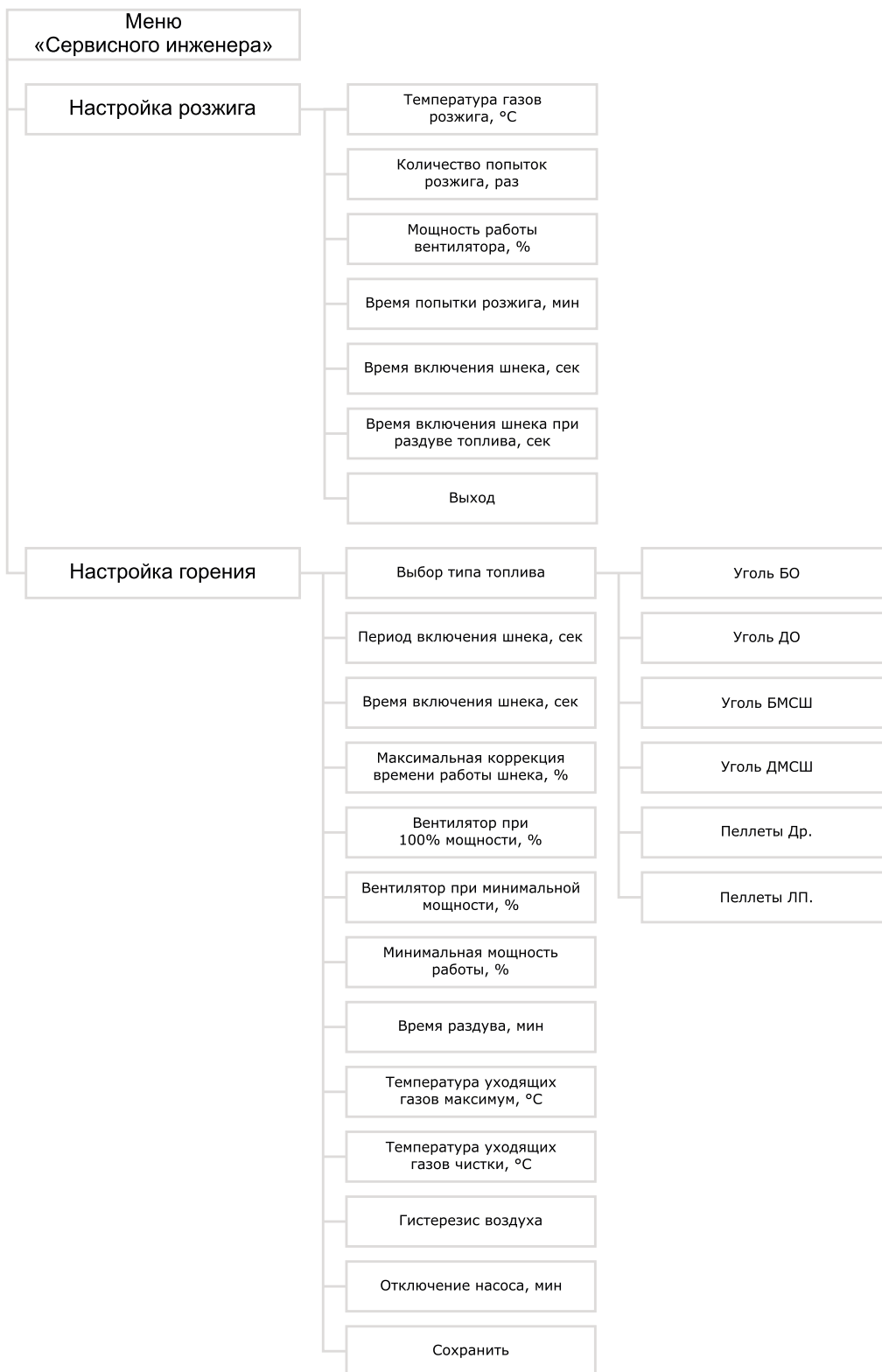
Рис.26 Блок-схема меню сервисного инженера (продолжение)
