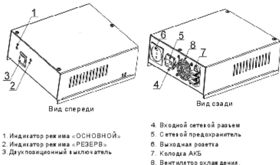
Рисунок 1 – Общий вид источника
