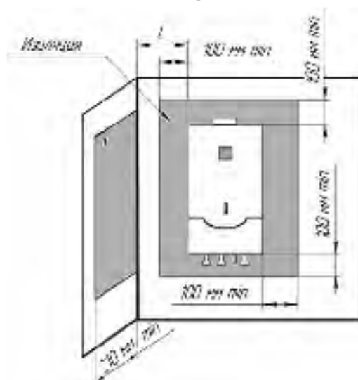
Рис. 1. Установка аппарата на трудносгораемых стенах.
