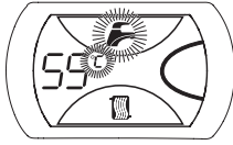
Рис. 5 Индикация настройки температуры ГВС
