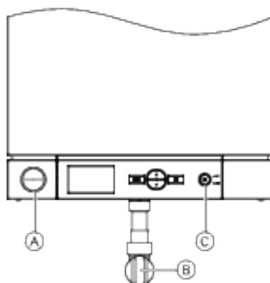
1. Проверить давление отопительной установки по манометру (A). Минимальное давление установки 0,8 бар (0,08 МПа). Если давление установки слишком низкое, в установку следует добавить воду или известить обслуживающую вас специализированную фирму по отопительной технике.
