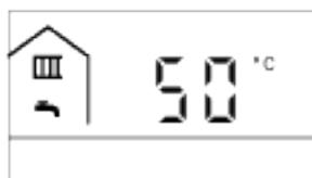
2. / для нужного значения. Диапазон настройки: от 30 до 57 °C (от 30 до 60 °C в режиме с емкостным водонагревателем).
