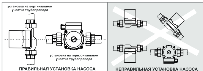
Рис.3 Установка циркуляционного насоса
