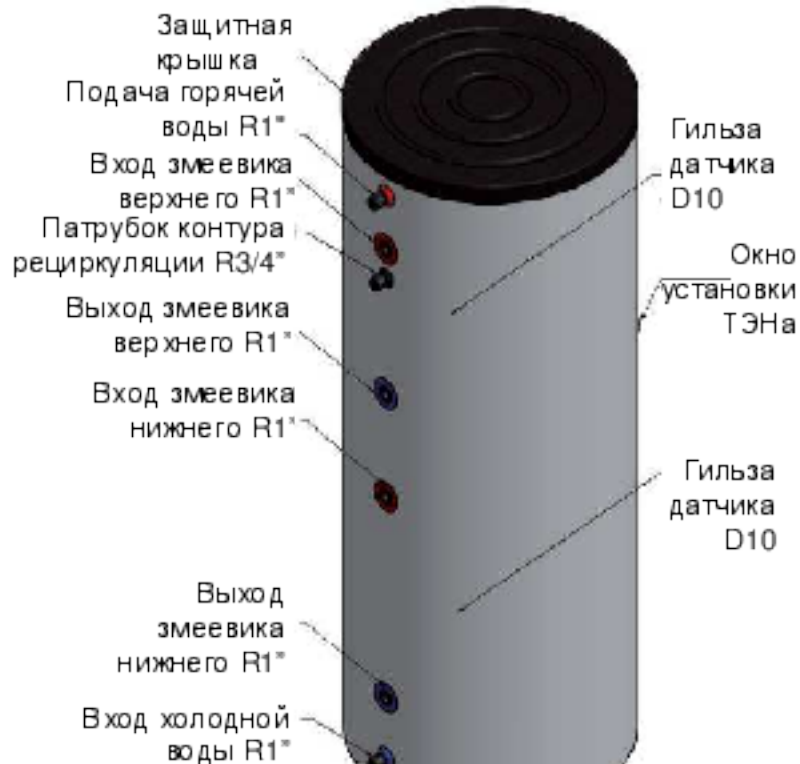
Водонагреватель с двумя теплообменниками-змеевиками 160-200 л
