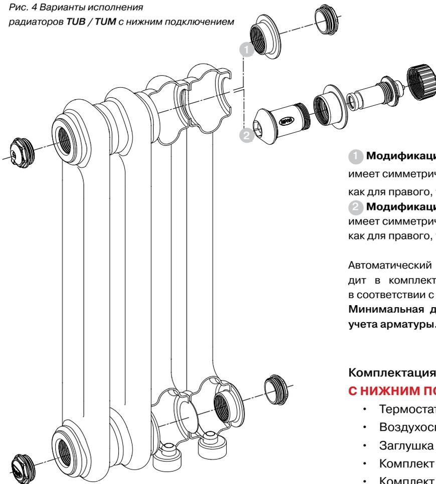
**1 Модификация TUBOG Ventil без клапана**
