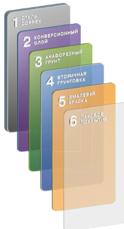
**ПОРОШКОВЫЕ** - стандартная окраска осуществляется новаторской технологией на автоматической тактовой линии покраски, оснащенной 11 станциями подготовки поверхности, ванной нанесения анафорезного грунта и камерой нанесения порошковой краски. Данная технология - уникальный инженерный проект компании RIFAR. Стандартный цвет - белый RAL 9016.
