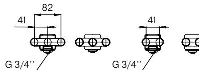
Радиатор RIFAR TUBOG с боковым подключением (схемы B1-B8) имеет симметричную конструкцию и может быть подключен по любой из схем. Заглушка и воздухоспускной клапан могут быть перенесены в соответствии с выбранной схемой монтажа.
