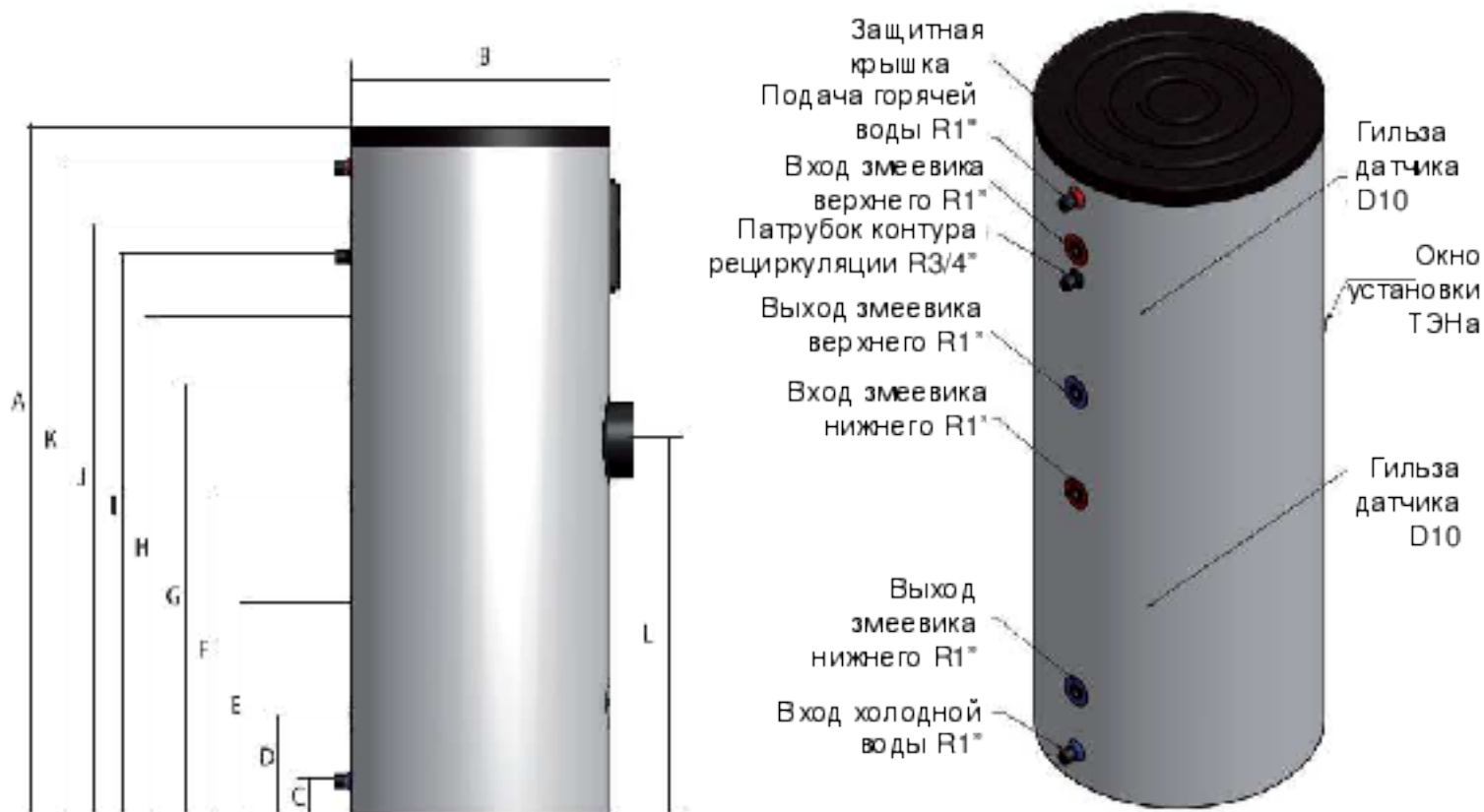
Водонагреватель с двумя теплообменниками-змеевиками 160-200 л
