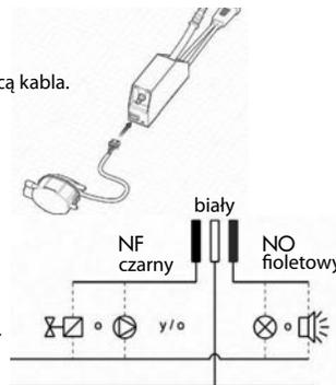
~ Do podłączenia alarmu służą styki NO/NF (normalnie otwarty/normalnie zamknięty), a moc rozłączania = 5A. Podłączyć alarm na podstawie schematu elektrycznego instalacji.
