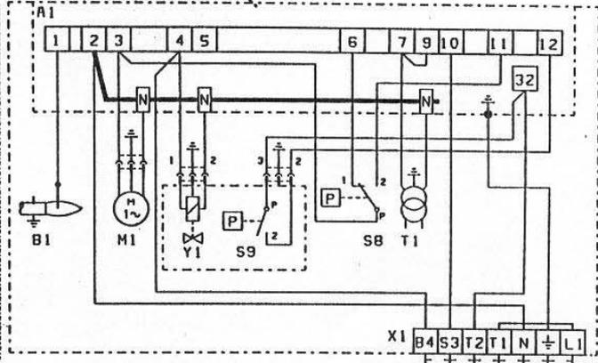
В случае отсутствия на котле разъема (X2) соединяющие соответствующих контактов горелки и котла производится самостоятельно.
