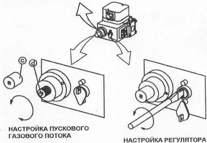
НАСТРОЙКА ПУСКОВОГО ГАЗОВОГО ПОТОКА
