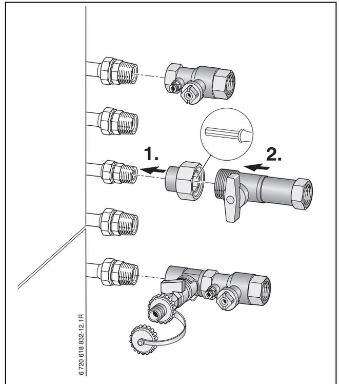
Рис 13 Монтаж сервисных кранов № 862 на примере подключений справа № 1334
