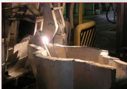
Разливка алюминия из плавильной печи
