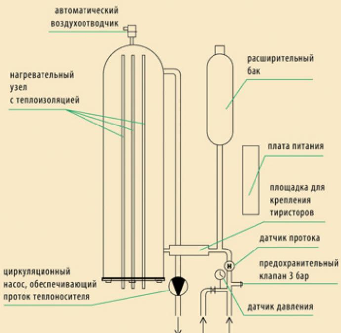
**Безопасность котла обеспечивается следующими защитными устройствами:**
