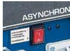
тока при сварке приведут к частому включению стартового усилителя и, соответственно, к перегреву генератора. Для этого предусмотрен специальный переключатель, который при сварочных работах необходимо перевести в положение Schweißbetrieb (режим сварки).
