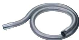
Гибкий металлический рукав длиной 1,5 или 2,5 м (в зависимости от типа) для отвода отработавших газов. Нельзя использовать в непроветриваемом помещении. Внимание! Опасность отравления
