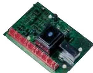
Устройство, контролирующее состояние изоляции между IT-сетью и защитным проводом на соответствие нормам VDE 0100 части 410 с аварийной индикацией.
