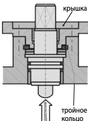
5) Для шпинделя шарового крана BROEN BALLOMAX®, монтируемого изнутри корпуса, используется тройное кольцо, защищающее шпиндель от вырывания из корпуса рабочей средой, находящейся под давлением. Герметичность по диаметру шпинделя и в отверстии корпуса создаётся тарельчатыми пружинами, которые оказывают постоянную осевую нагрузку на уплотнительный набор из фторопласта (PTFE) (см. рис. 1).
