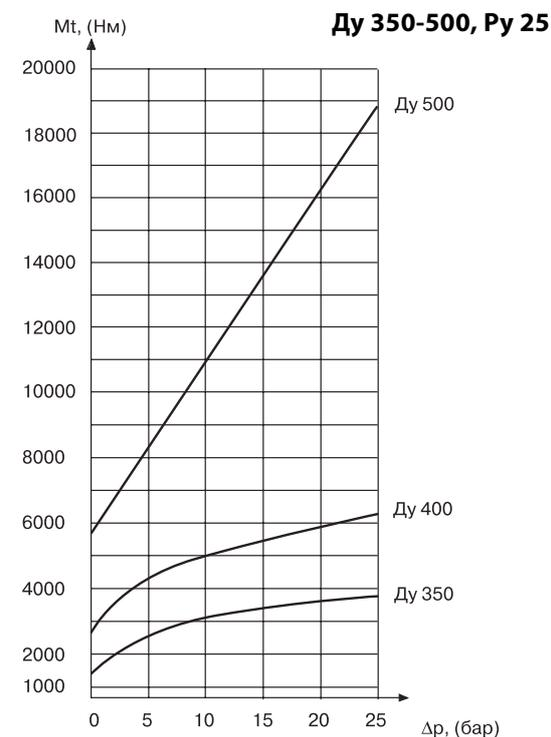
Указанные значения усилий, необходимые для закрытия крана, – это ориентировочные значения, полученные в результате измерений. Измерения проводились на шаровых кранах, которые не были в эксплуатации. Данная характеристика подразумевается как момент отрыва для шаровых кранов, которые закрыты и находятся в таком положении непродолжительное время.
