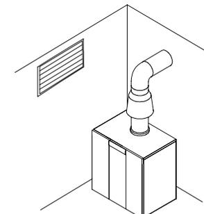
После подключения внешнего дефлектора к котлу, подключение к существующей системе дымоудаления (дымохода) так же как и у котлов с внутренним дефлектором.
