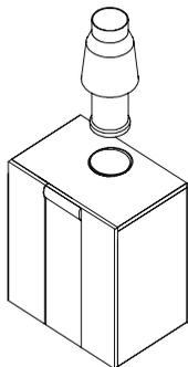
При использовании внешнего дефлектора – датчик дымовых газов следует установить в дефлекторе, согласно рисунку.
