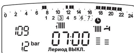
Наряду с изменением интервала времени, дисплей с помощью индикатора часов указывает выбранное время с шагом 15 мин. По завершении изменения интервала предварительно заданной программы, нажимая кнопку "Таймер-программатор", выберите другой интервал, в нашем примере это период с 07:00 по 22:00.
