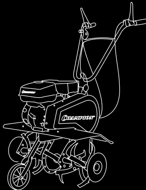
Культиваторы Champion — это универсальные машины, оснащенные двигателем внутреннего сгорания, предназначенные для обработки почвы фрезами. Культиваторы Champion могут быть оборудованы дополнительным навесным оборудованием: плугокучник, плуг-отвал, копалка и пр.
