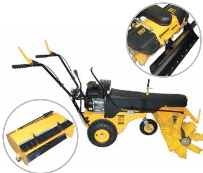
Машина предназначена для уборки небольших площадок и дорожек с твердым покрытием, оснащена отвалом и мусоросборником.
