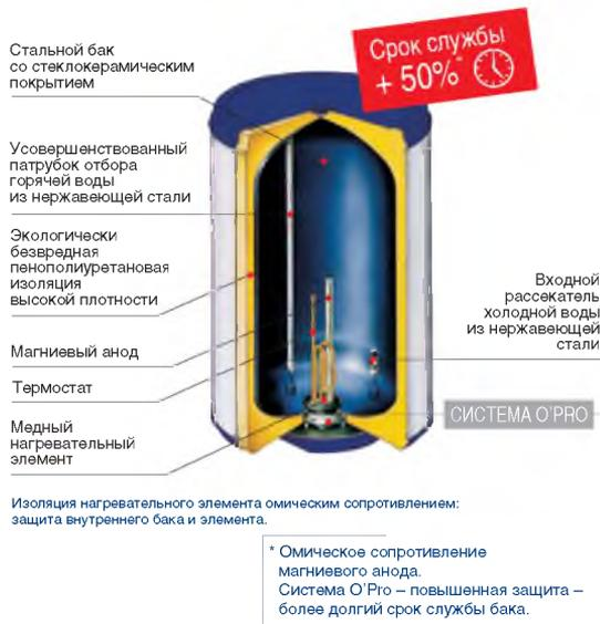
При открытии крана горячей воды в водонагреватель через трубку подачи холодной воды начинает поступать холодная вода. Холодная вода, вытесняя снизу, вытесняет ранее нагретую воду через трубку горячей воды, идущей из верхней точки аппарата.
