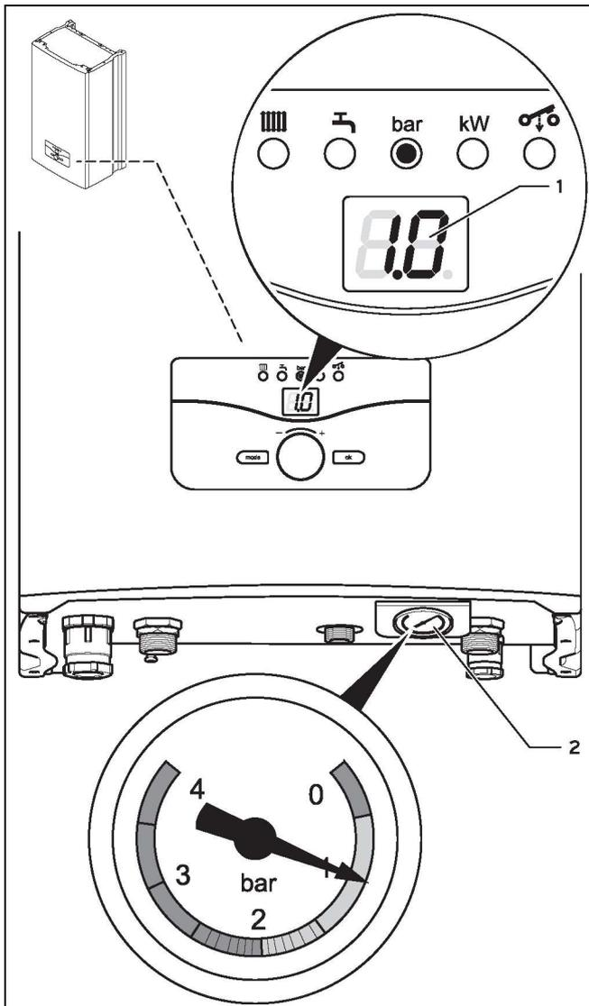
Рис. 5.10 Проверка давления наполнения системы отопления
