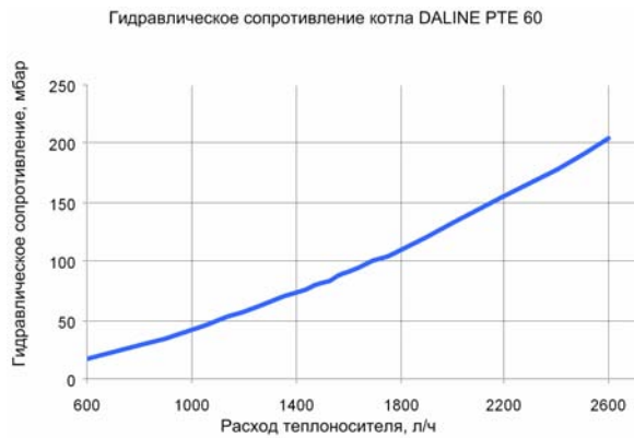
Рис.17. Гидравл. потери котла «Daline PTE 22-60»
