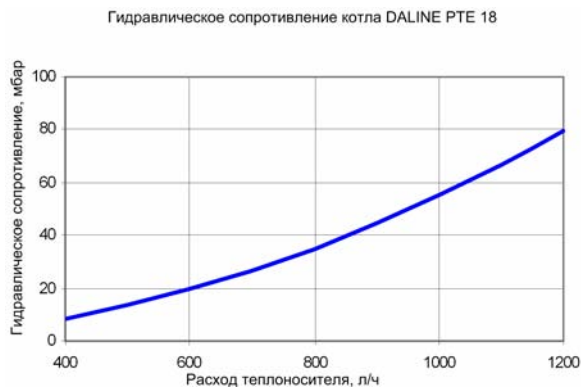
Рис.16. Гидравл. потери котла «Daline PTE 4-18»
