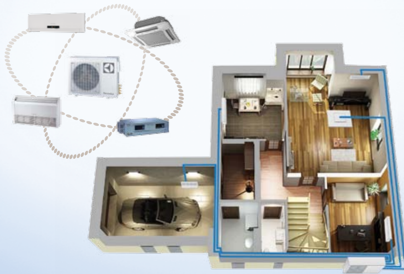
Схема работы мульти сплит-системы Super Match
