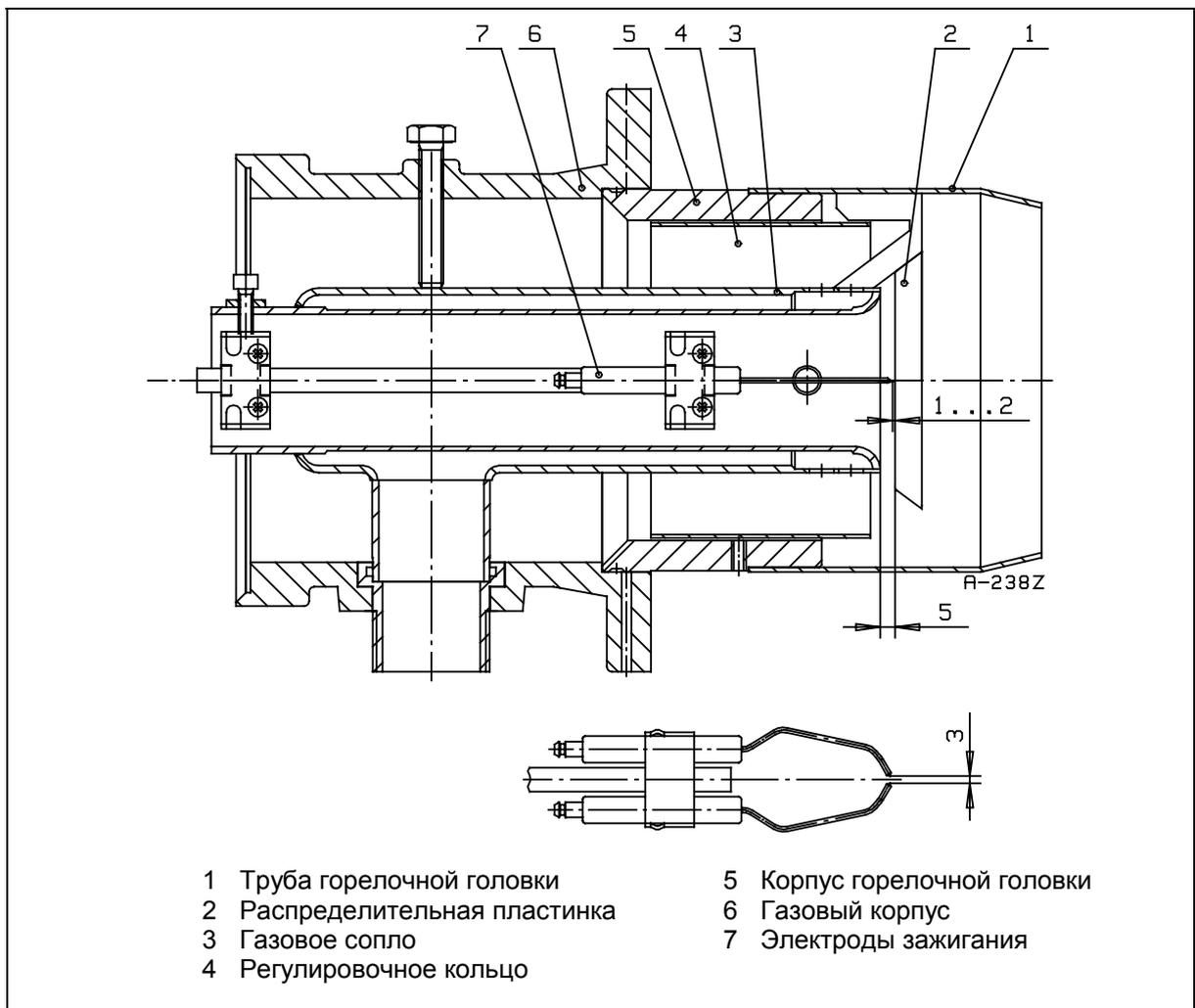
**Вним.!** Если положение регулировочного кольца относительно распределительной пластинки изменяется, меняются также скорость прохода и объем воздуха. Проверьте качество сжигания по анализу дымовых газов и, при надобности, подрегулируйте расход воздуха.
