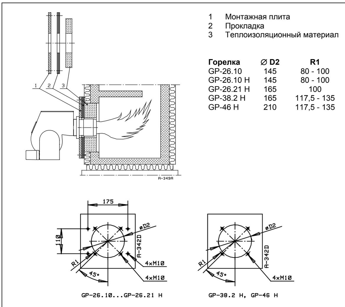
Для крепления горелки к монтажной плите следует сделать отверстия с резьбой M10 по чертежу.
