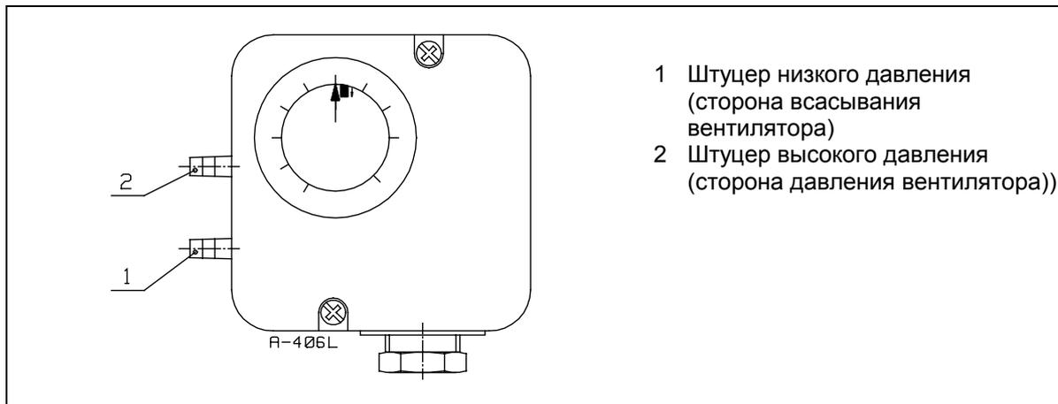
Дифференциальное реле давления воздуха контролирует перепад давления воздуха в горелке. Если перепад давления не превышает установленного в реле значения, горелка останавливается. Дифференциальное реле должно срабатывать до увеличения содержания CO в дымовых газах выше 1 % (10 000 ppm).
