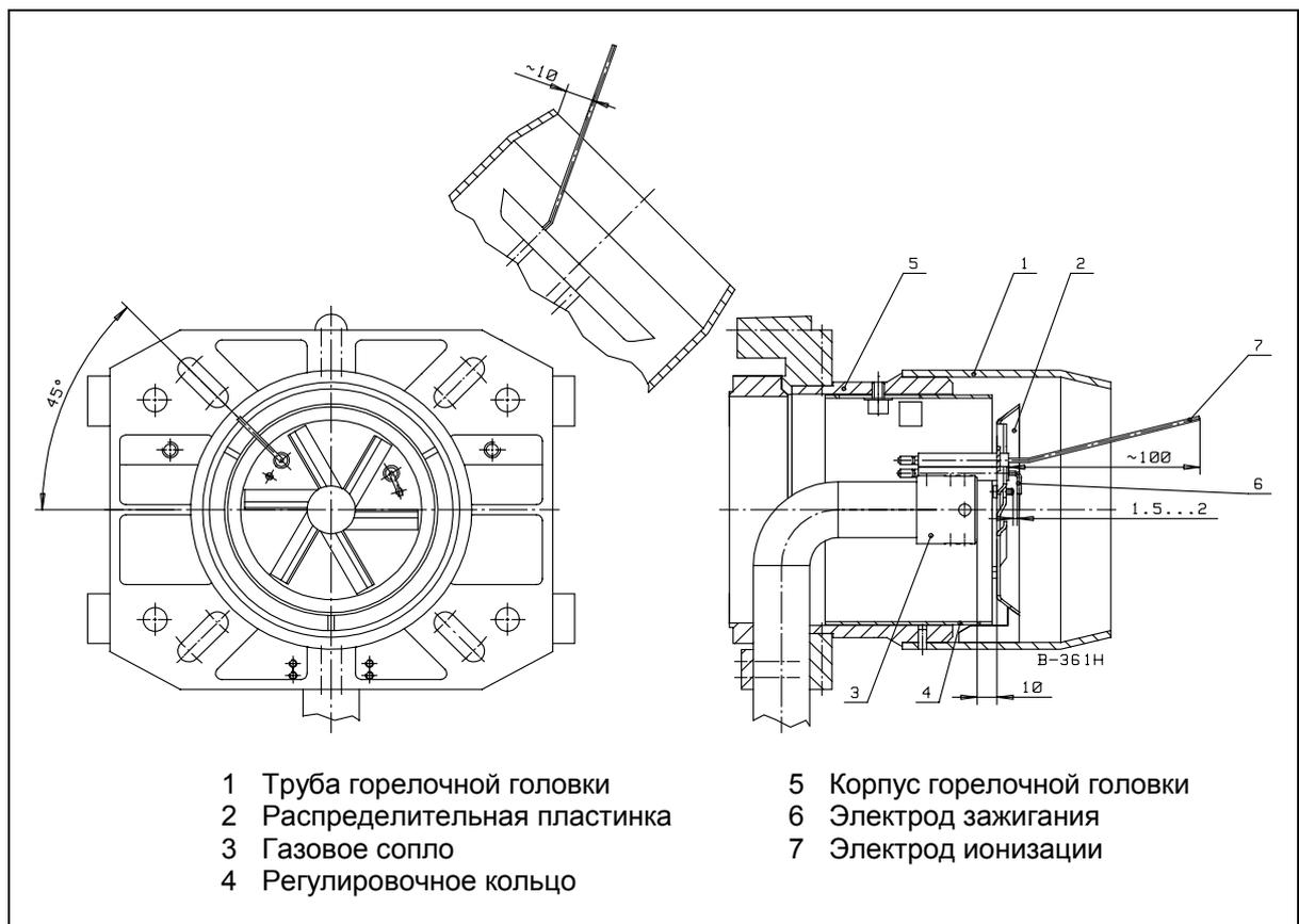
**Вним.!** Если положение регулировочного кольца относительно распределительной пластинки изменяется, меняются также скорость прохода и объем воздуха. Проверьте качество сжигания по анализу дымовых газов и, при надобности, подрегулируйте расход воздуха.
