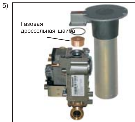
Вытащить газовую дроссельную шайбу и заменить ее на дроссельную шайбу, предназначенную для сжиженного газа.
