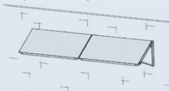
Рис. 249. Монтаж солнечных коллекторов на фасаде
