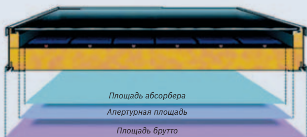
Рис. 147. Виды поверхности плоского солнечного коллектора
