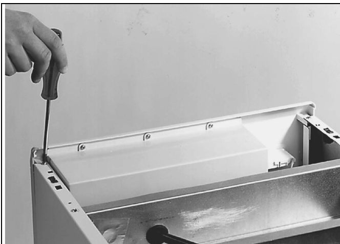
Фото А. Отвинтить крепежные винты
