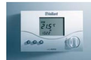
**calorMATIC 240** – термостат помещения с таймером ДЕНЬ/НОЧЬ с программированием на неделю. 220 В (Клеммы 3-4). Электропитание от батареек. Для автоматического управления комнатной температурой в диапазоне 5...30 С. Три различных программы отопления на неделю. Не рекомендуется применять для управления установками мощностью более 25 кВт во избежание снижения комфорта эксплуатации.
