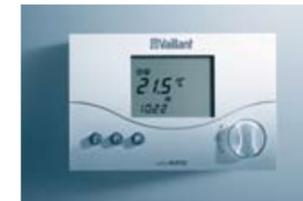
**calorMATIC 230** – термостат помещения с таймером ДЕНЬ/НОЧЬ с программированием на неделю. 220 В (Клеммы 3-4-5). Для автоматического управления комнатной температурой в диапазоне 5...30 С. Три различных программы отопления на неделю. Не рекомендуется применять для управления установками мощностью более 25 кВт во избежание снижения комфорта эксплуатации.
