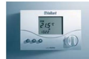
**calorMATIC 330** – управление в зависимости от температуры в помещении, двухпозиционное (ВКЛ./ВЫКЛ.) или непрерывное регулирование, кварцевый таймер с программированием на неделю для автоматического снижения температуры в ночное время.
