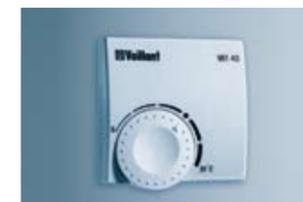
**VRT 40** – комнатный регулятор температуры, непрерывное и двухпозиционное регулирование в зависимости от комнатной температуры. Постоянное напряжение 24 В (Клеммы 7-8-9).
