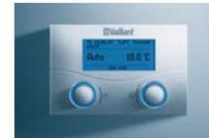
**calorMATIC 430** – регулятор с интерфейсом передачи данных стандарта e-bus, регулирование в зависимости от температуры наружного воздуха и по температуре воздуха в помещении при монтаже на стене, управление одним прямым контуром отопления. При использовании дополнительных блоков управляет циркуляционной линией ГВС и дополнительным смесительным контуром отопления любого типа.
