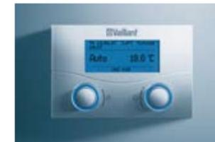
**calorMATIC 392** – регулятор с интерфейсом передачи данных стандарта e-bus, управление в зависимости от температуры в помещении, двухпозиционное (ВКЛ./ВЫКЛ.) или непрерывное регулирование. Оснащён цифровым таймером с программированием на неделю для автоматического снижения температуры в ночное время и управления нагревом воды при использовании водонагревателя косвенного нагрева. При использовании дополнительных блоков управляет циркуляционной линией ГВС.
