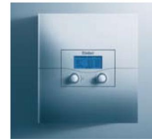
**calorMATIC 630/2** – новое интеллектуальное устройство регулирования с двухпроводным интерфейсом стандарта e-bus для соединения всех компонентов системы. Управление отоплением и горячим водоснабжением по таймеру с программированием на неделю. Управление 2-мя контурами отопления со смесителем, 1 нерегулируемым контуром отопления, 1 контуром емкостного водонагревателя с насосом и циркуляционным насосом системы горячего водоснабжения.
