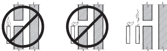
Рис. 3 Способ проверки тяги в дымоходе
